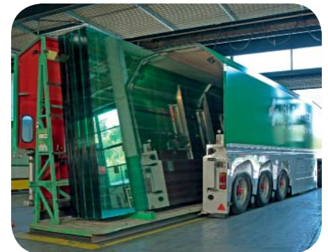
Aus Gelsenkirchen in alle Welt: Großformatige Funktionsgläser (6 m x 3,21 m) werden in speziellen Innenladern transportiert.
