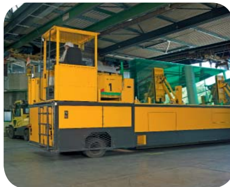
Innerbetriebliches Glastransportfahrzeug im Verbund-sicherheitsglasbetrieb.
