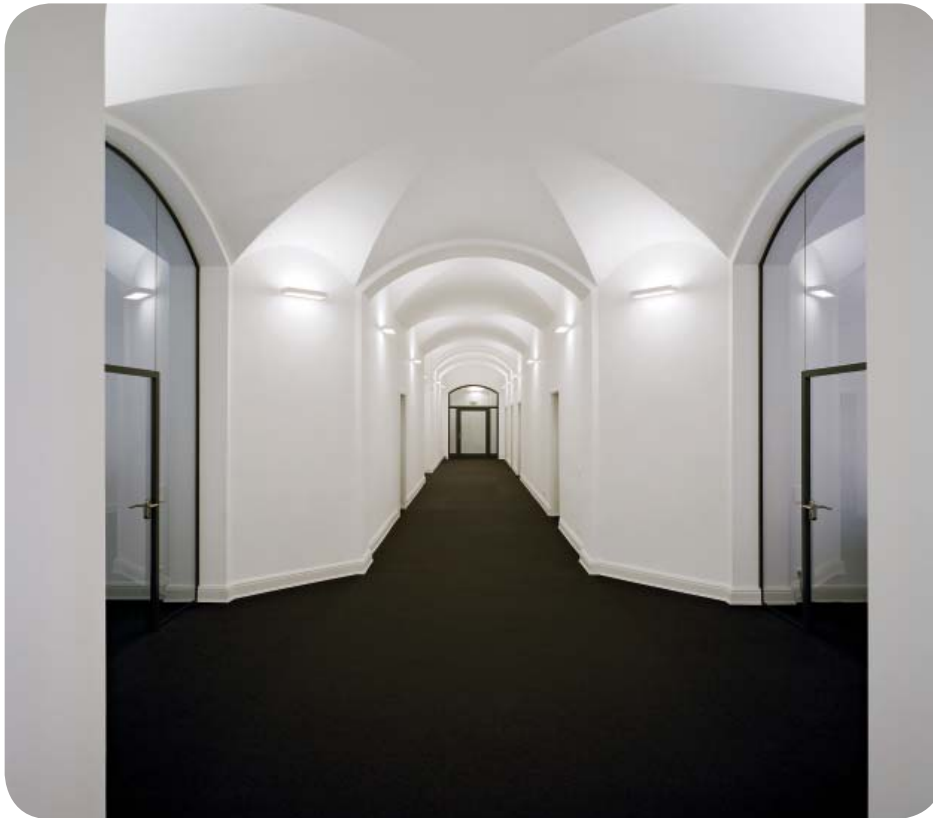
Brandschutz meets Rauchschutz: Im historischen Bauteil 2 wurden lange Flure zur Bildung von Brand- und Rauchabschnitten mit EI(T) 30-Türen und Rauchschutz-Türanlagen neu unterteilt. Fotos: Fotografie Dorf Müller Klier.
